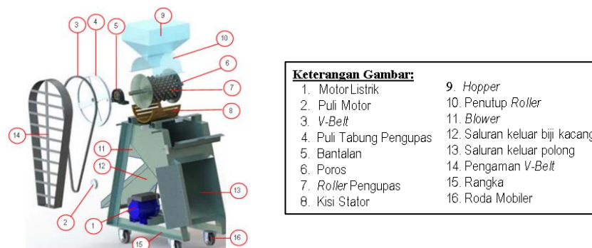
Gambar 4 . Desain Mesin pengupas kulit kacang tanah
