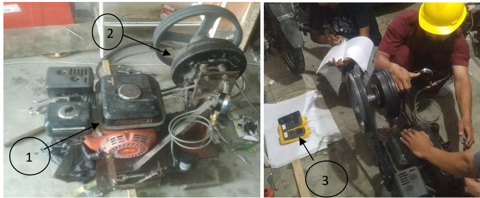
Gambar 6. Alat uji rem : 1) Motor penggerak, 2) Rem tromol, 3) Thermocouple
