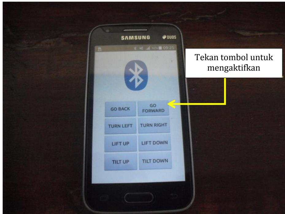
Gambar 7. Tampilan aplikasi kontroler pada smartphone android
