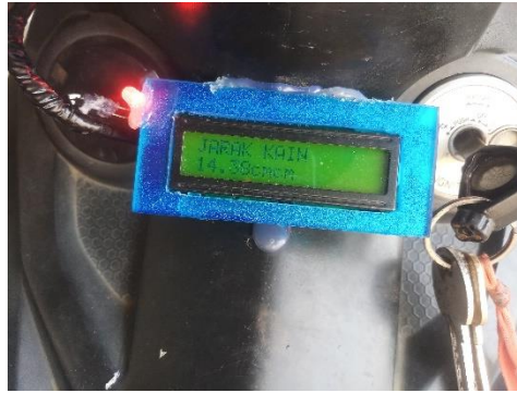
Gambar 8. Tampilan LED dan LCD ketika mendeteksi rok atau hijab pada jarak kurang dari 15 cm.
