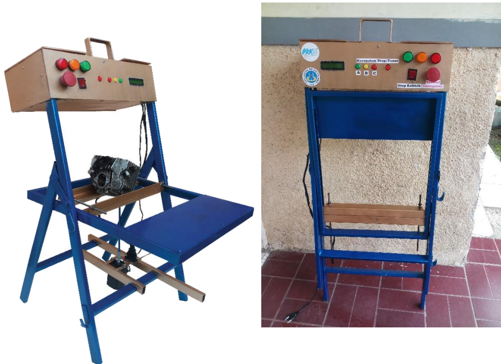
Gambar 4. Tampilan Hasil Rancang Bangun Alat Penyekir Katup Otomatis Berbasis Microcontroller
